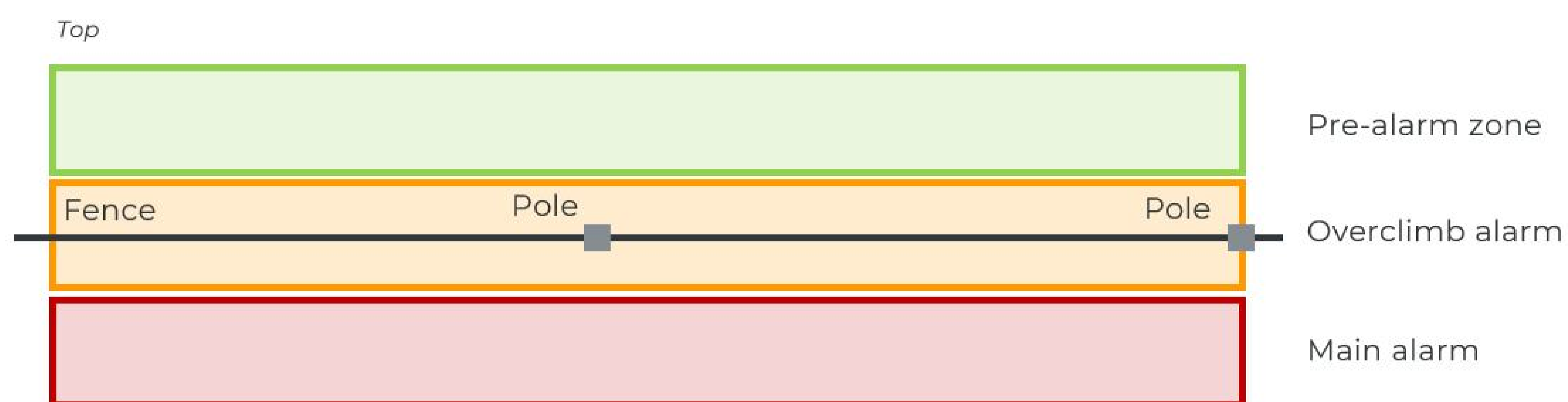
Grafisches Beispiel für Alarmzonen zur Zaunsicherung
